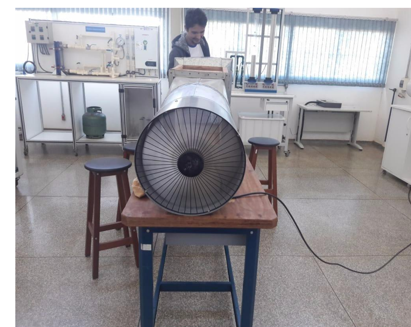
Figura – 3: Saída de ar com ventilador/exaustor
