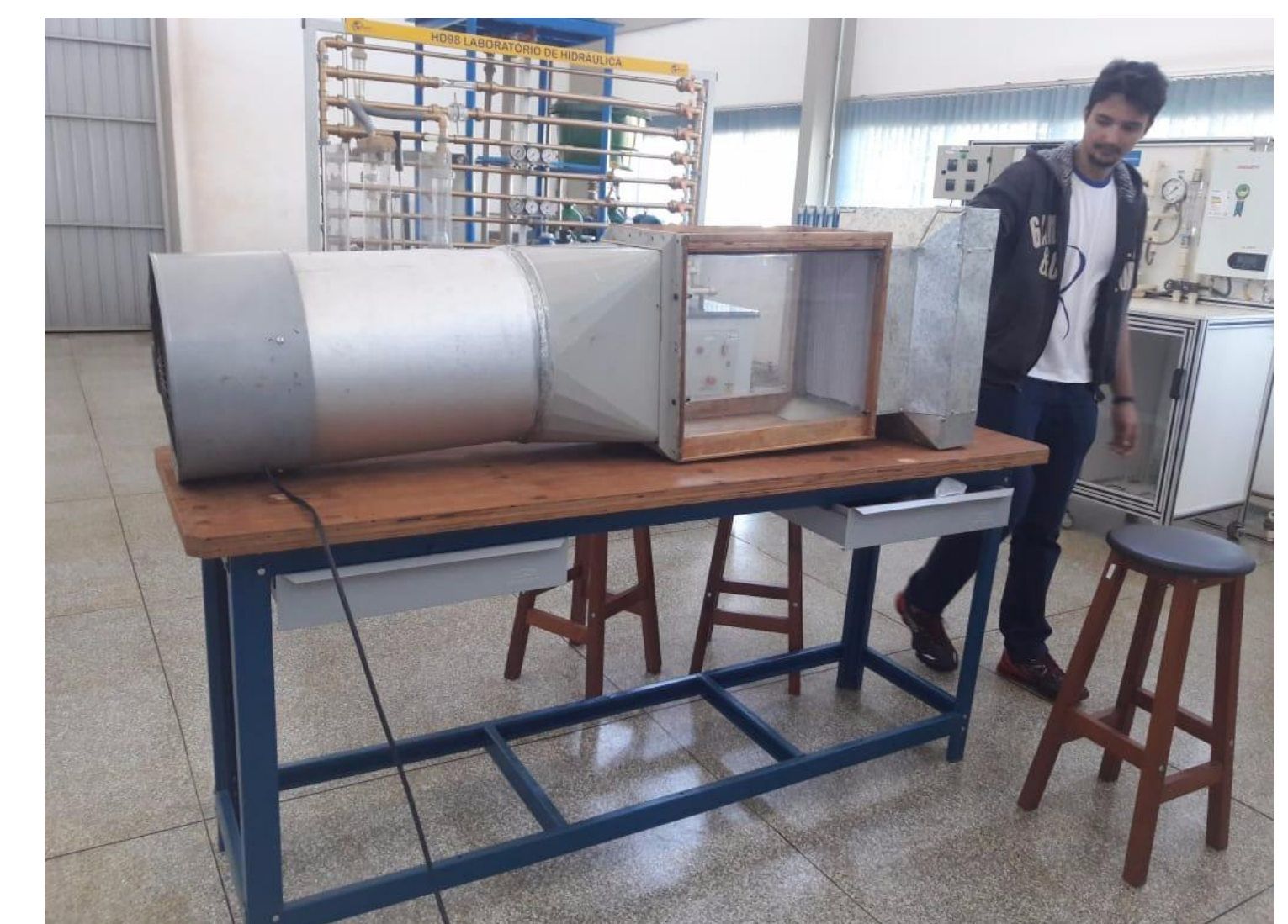
Figura – 2: Vista lateral-Destaque para a seção de ensaio em vidro
